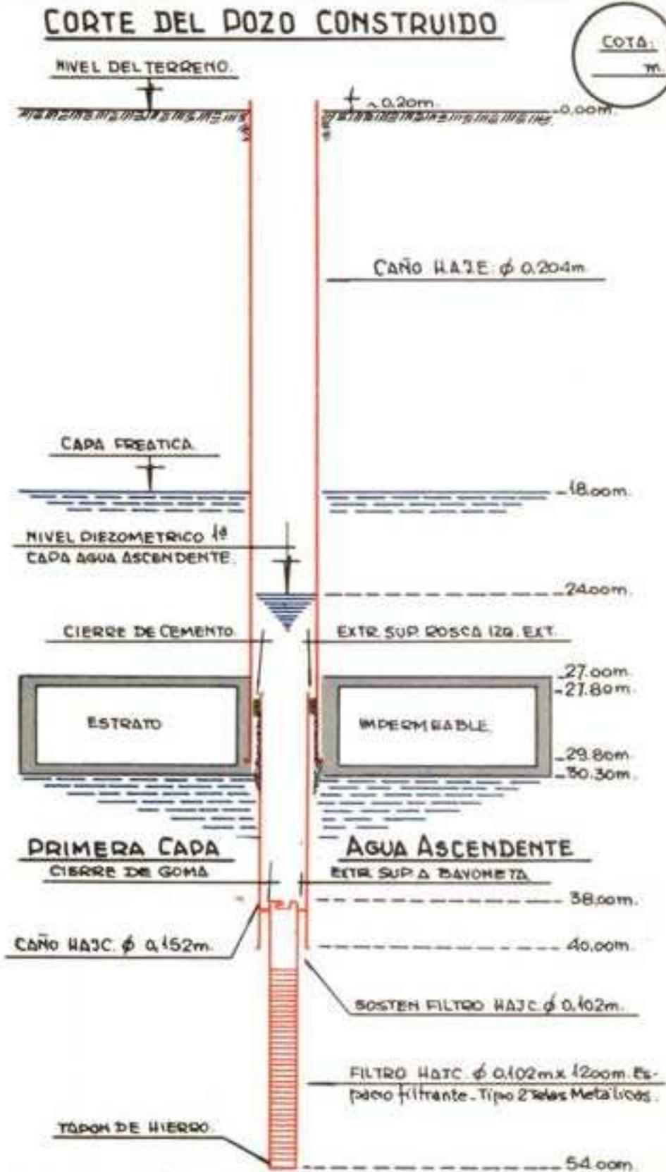
**NOTA:** Para descenso del filtro se bajo la cañería de HAZC  $\phi$  0.102m. hasta la profundidad total, levantando luego esta. quedando a las cotas indicadas.
