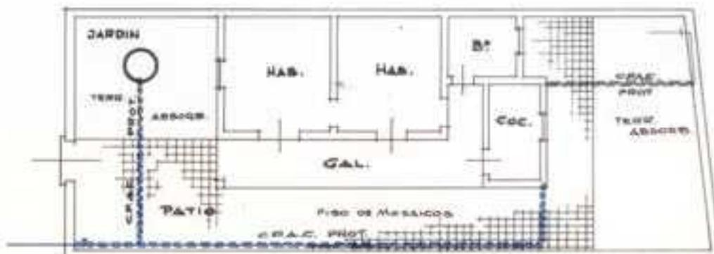
EN TODOS LOS CASOS EN QUE LA CAÑERIA DE AGUA CORRIENTE DE PLOMO VAYA BAJO PISO DEBERA SER PROTEJIDA DEBIDAMENTE CON HIERRO GALVANIZADO, HOSEHICOM O OTRO MATERIAL CONVENIENTE
